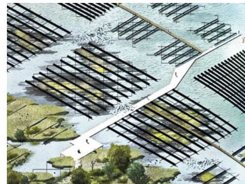
Drijvende PV-modules die voor verlanding zorgen Bron: David de Boer [uit de Blauwe Kamer], 2021
