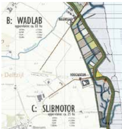
De 'dubbele dijk' laat het binnendijkse gebied zien tussen de twee dijken. Het bovenste deel (tot de versmalling) is voor aquacultuur en innovatieve landbouw en het onderste deel voor slibwinning.
