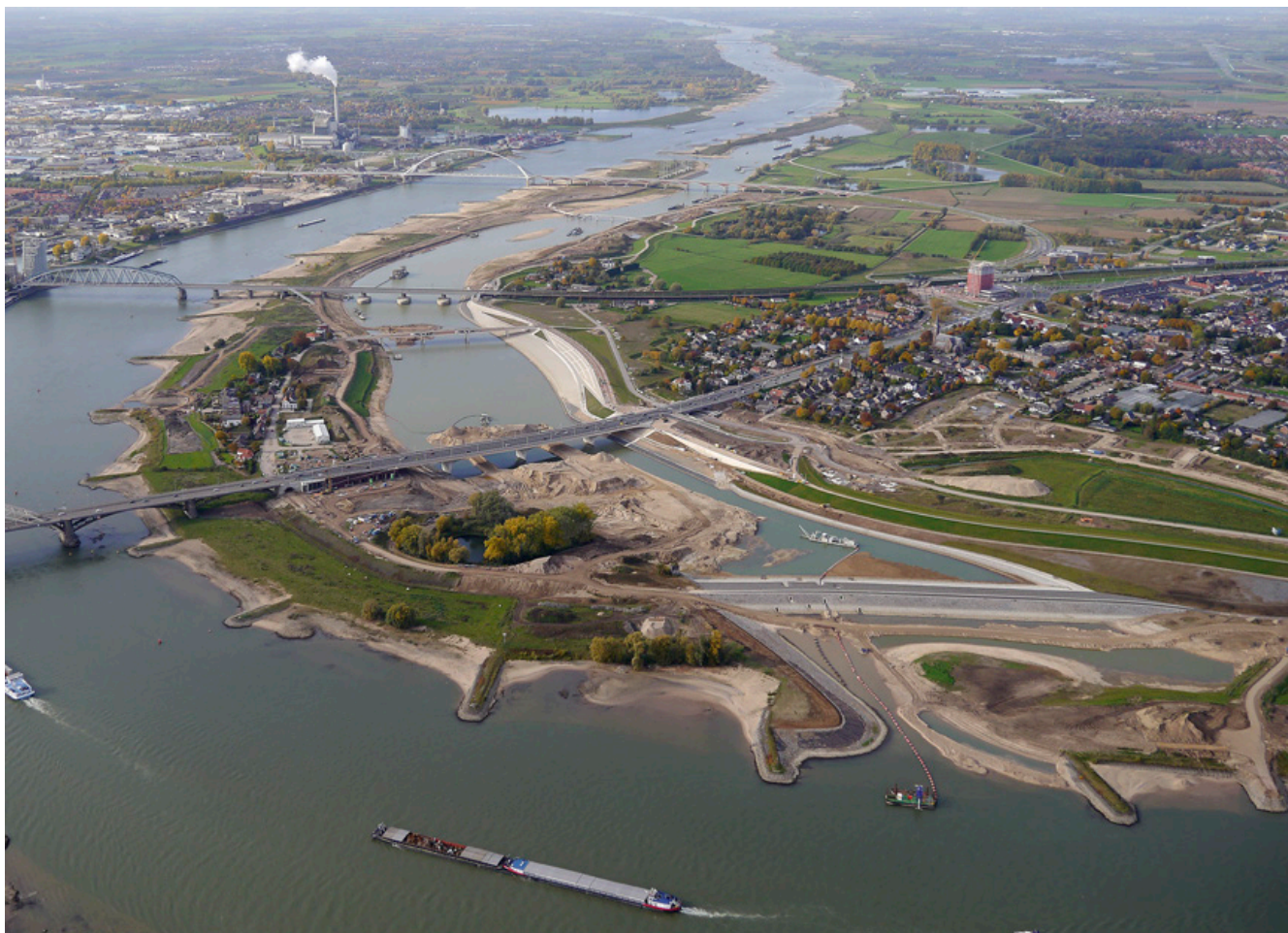
De onlangs opgeleverde by pass in de Waal bij Lent, die de rivier meer ruimte geeft. Foto: Johan Roerink Aeropicture
