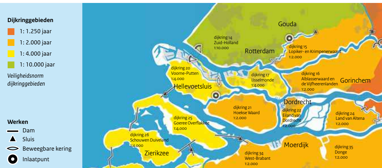
Figuur 2: Watersysteem inclusief veiligheidsvoorzieningen en twee belangrijke inlaatpunten voor zoetwater in de Rijn-Maasmonding.
