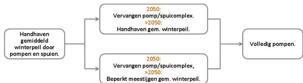
Figuur 5.1: Adaptatiepad waterafvoer - mogelijke ontwikkelingen binnen de geformuleerde strategie voor de waterafvoer.
