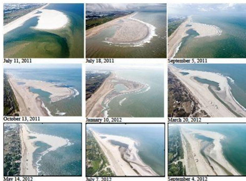
Figuur 35 Verloop van het aanspoelen van de zandmotor bij Ter Heijde, Zuid-Holland. Zandmotor is een voorbeeld van een innovatieve suppletievorm (bron: Rijkswaterstaat).
