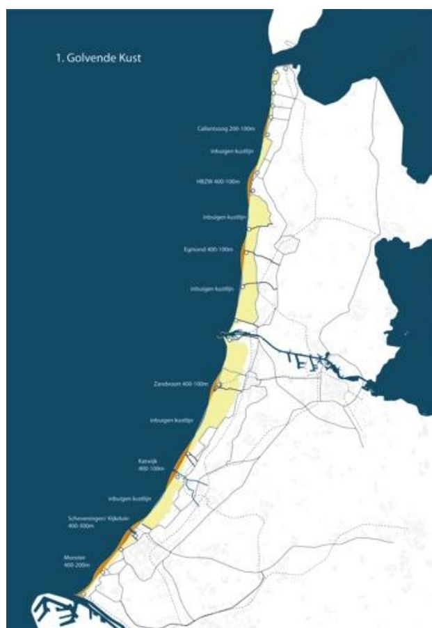
Figuur 41 Ontwerpstudie naar de vormgeving van zandsuppleties bij huidige zeespiegelstijging, voor verschillende functies van de Hollandse Boog. Hier is weergegeven het model 'golvende kust', waarbij het zand wordt geconcentreerd rondom badplaatsen en toekomstige aandachtslocaties in de kustverdediging. Badplaatsen winnen hierdoor aan ruimte. Brede duingebieden ontvangen minder zand (bron: Atelier Kustkwaliteit/Feddes & Olthof).
