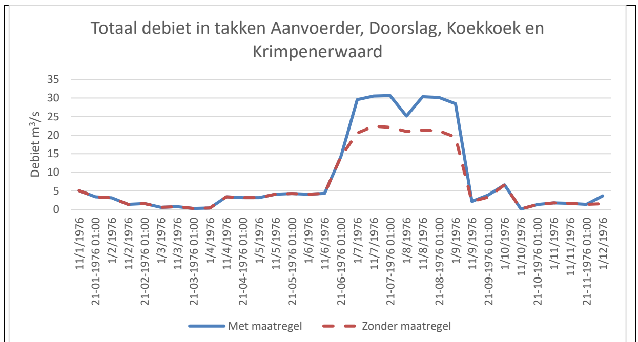
Figuur Q14-3 Som van debieten in de KWA takken in 1976, scenario STOOM2050, met (blauw) en zonder (rood) maatregel.
