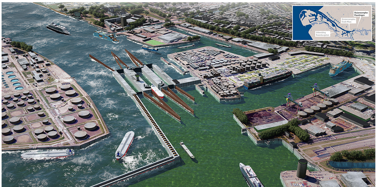
Figuur B.1: artist impression van de sluis in Nieuwe Maas ter hoogte van Vlaardingen in het plan van F. Spaargaren et al. Bron: Frédéric Ruys, Vizualism , 2016
