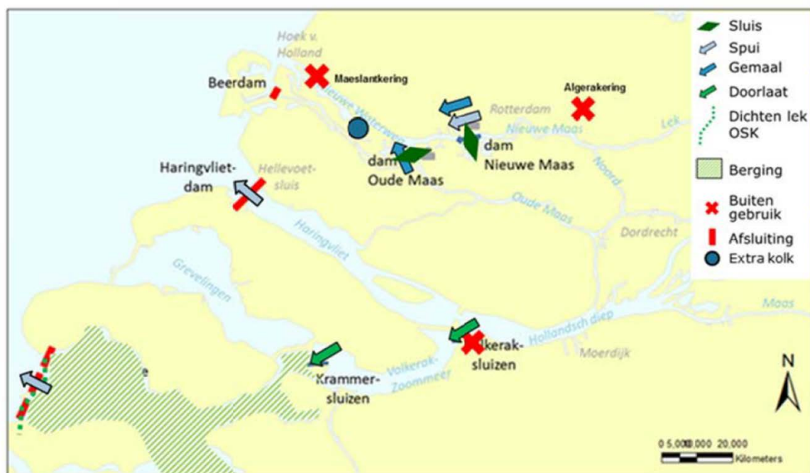
Figuur 2.3. Overzicht van de belangrijkste infrastructurele maatregelen in Plan Sluizen (bron: Rijkswaterstaat 2015)
