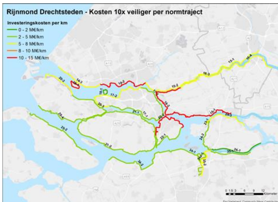
Figuur 7 Kosten voor het bereiken van een 10 maal kleinere faalkans (per km dijk) per normtraject. Kosten zijn totale investeringskosten, prijspeil 2009, inclusief BTW. (Hollandse IJssel ontbreekt hier omdat deze later is toegevoegd).
