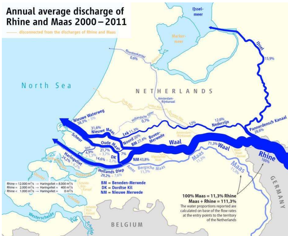
Afbeelding 1. Huidige regulering van de afvoer van Nederlandse rivieren met Nieuwe Waterweg als hoofdafvoer van Rijn en Maas. Bron: Dörrbecker (Chumwa) 2016 .
