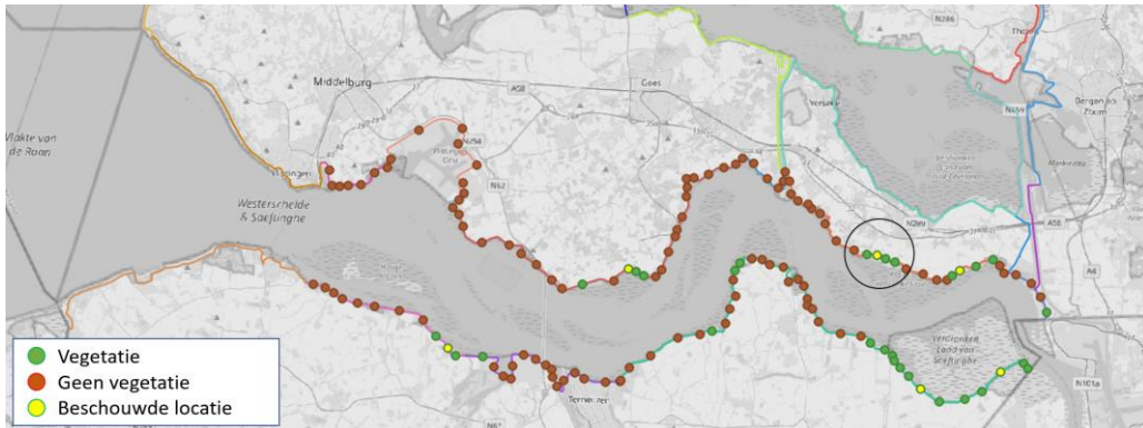
Figuur 56: Locaties in de Westerschelde waar op basis van de ecotopenkaart Westerschelde 2020 wel (groen) of geen (rood) vegetatie op het voorland aanwezig is. In geel de beschouwde locaties voor de gevoeligheidsanalyse. Platen van Valkenisse (zie cirkel) is een beschouwde locatie waarbij vegetatie op het voorland een reductie heeft van 10% op de significante golfhoogte bij de buitenteen.
