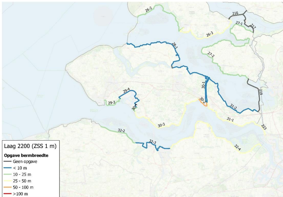
Figuur 37: Waterveiligheidsopgave voor sterkte bij 1 m zeespiegelstijging (tijdlijn Laag 2200) bij het bodemscenario Volledig Meegroeien in de Westerschelde.
