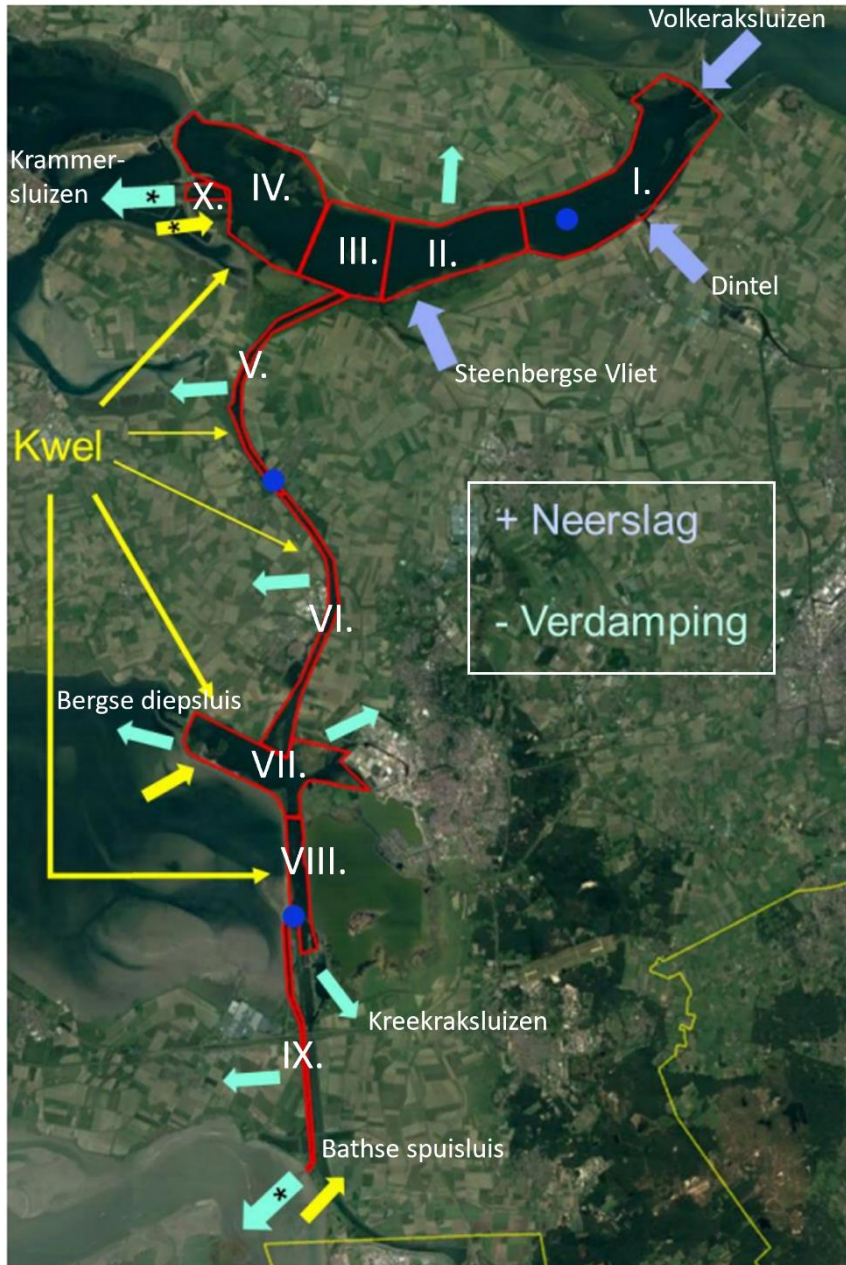
Figuur 3-2 Verdeling van de bakjes in het bakjesmodel en in- en uitgaande posten (Deltares, 2020).
