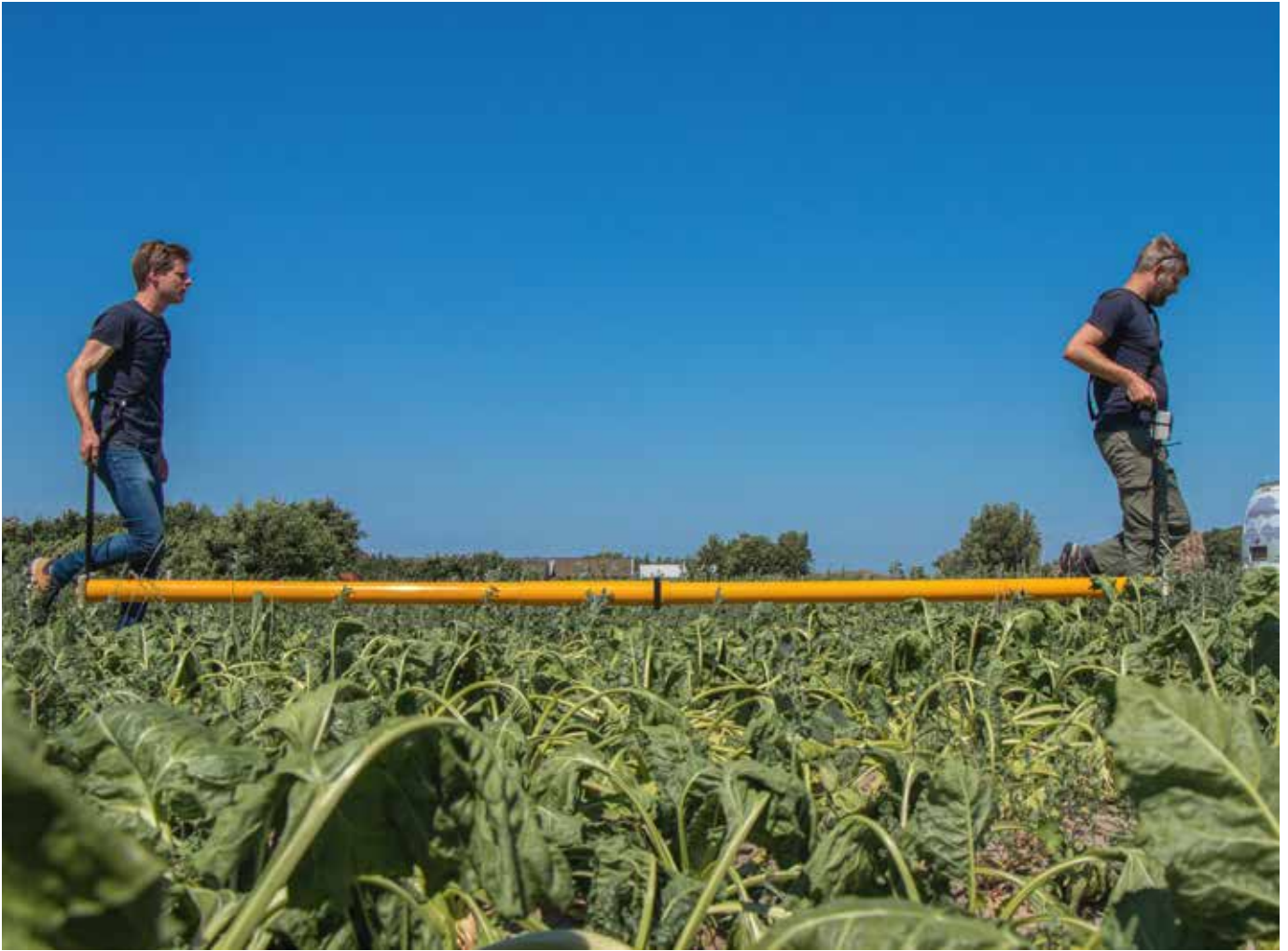
Twee werknemers van Acacia Water doen op Texel geofysische metingen om de kwaliteit van het grondwater te onderzoeken
