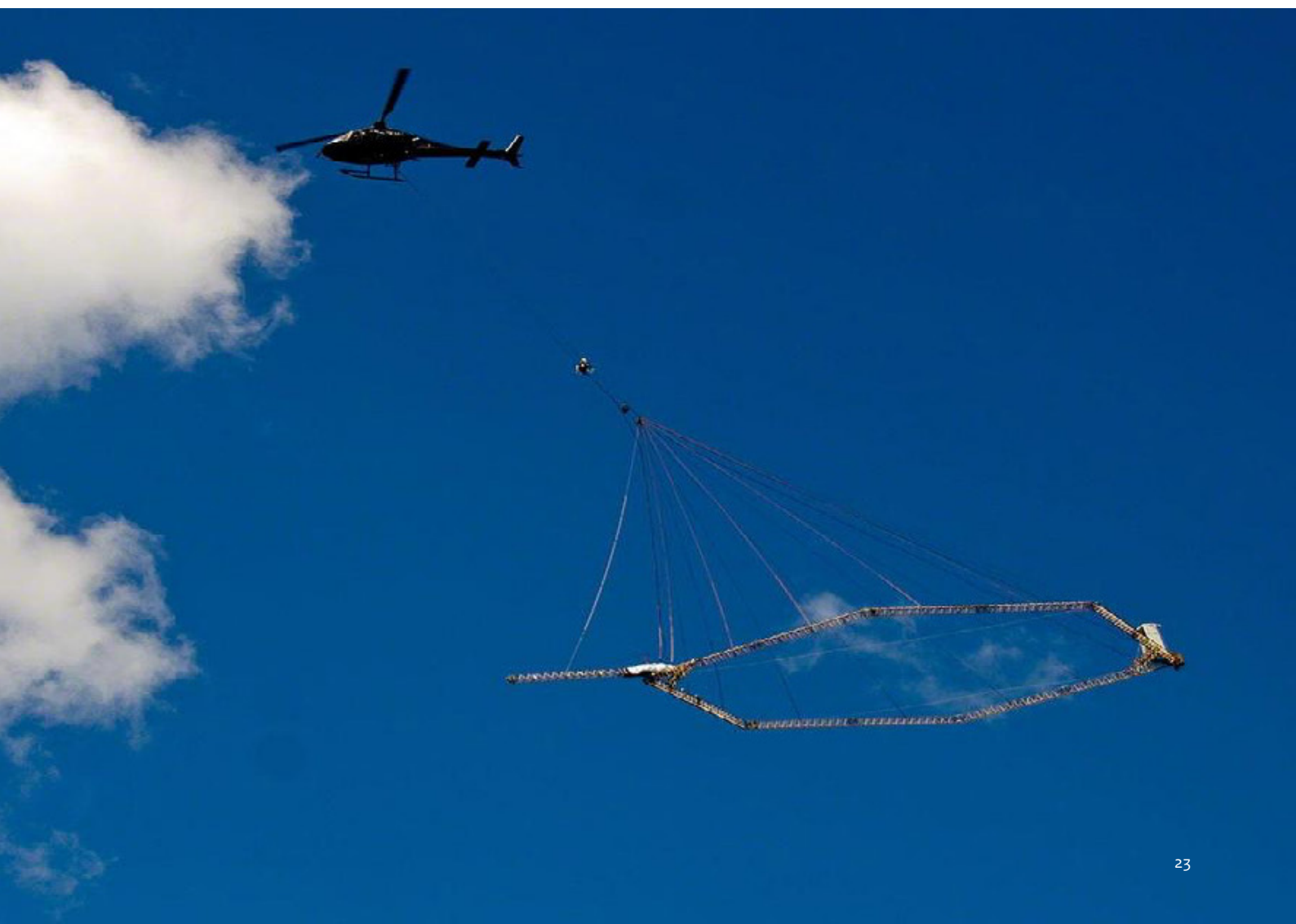
Figuur 12 Metingen van de ondergrond vanuit een helikopter voor FRESHEM-NL
