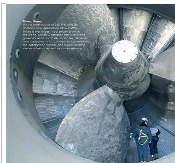
Afbeelding 3.4. Bulbturbine getijdenplant Shiwa in Zuid Korea (bron: Andritz Hydro)
