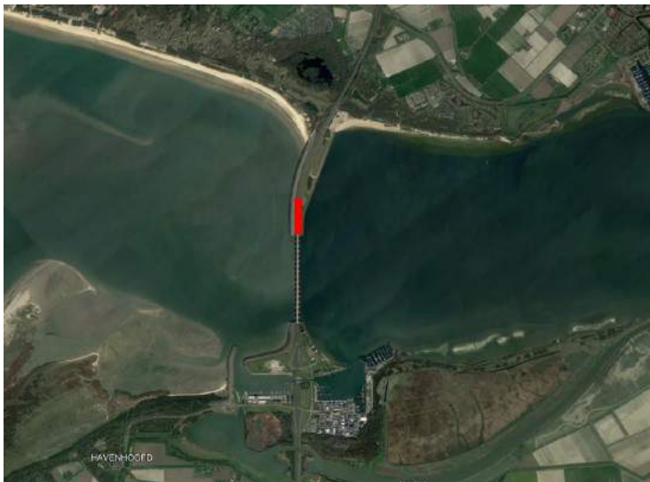
Afbeelding 2.7. Inrichting Grevelingensluizen. Rood = benodigd ruimtebeslag voor benodigd spuidebiet (=1.500 m)
