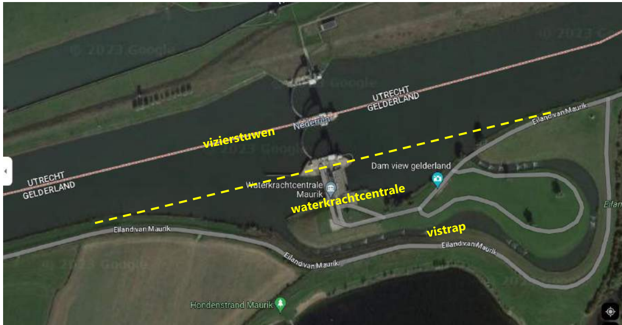
Afbeelding 3.12. Satellietbeeld van de waterkrachtcentrale bij Maurik in de Nederrijn. De gele stippellijn laat de normale rivierloop zien. De waterkrachtcentrale is buiten de normale rivierloop geplaatst
