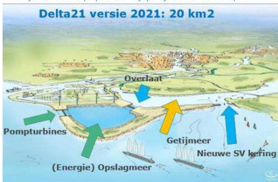
Afbeelding 3.7. Combinatie van pompturbines en de getijdenlagune van het Delta21 concept
