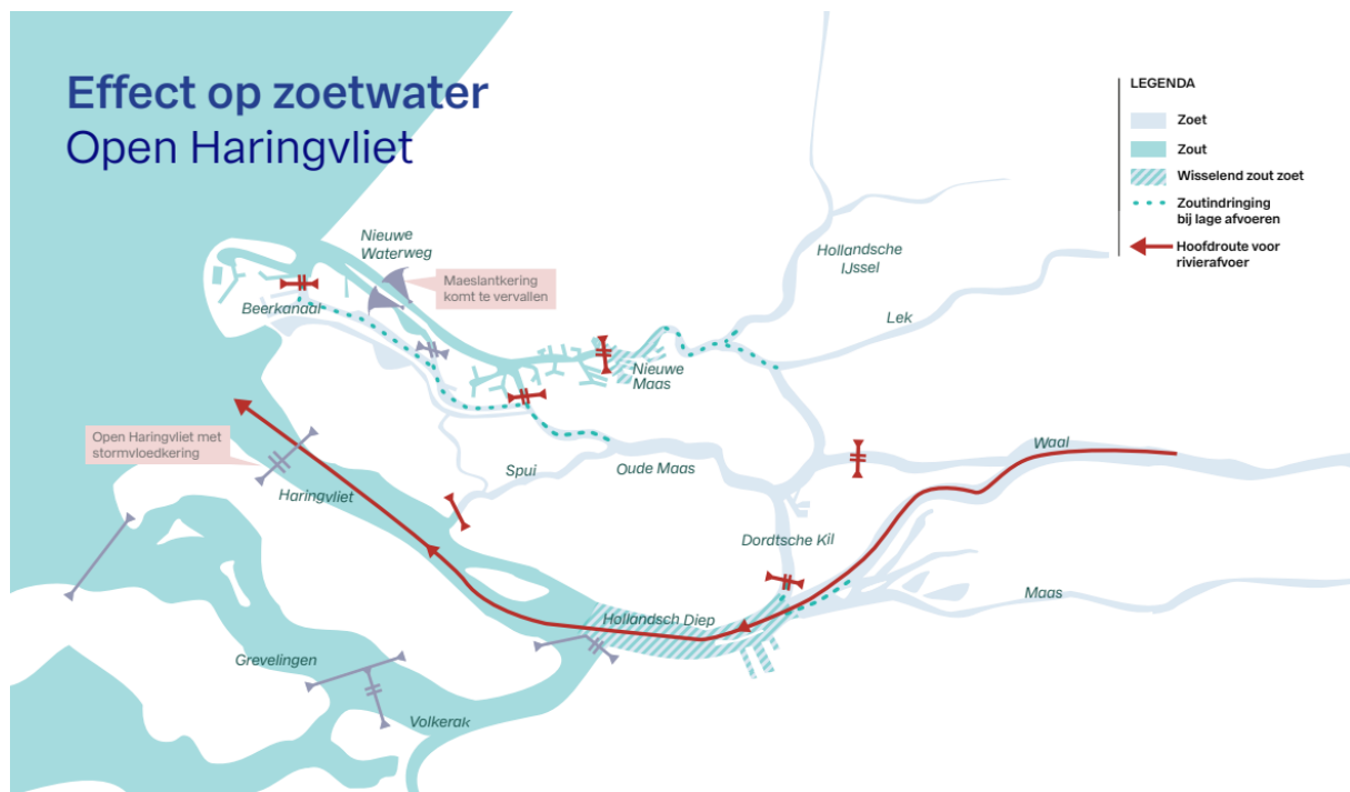
Figuur 23: Effecten op zoutindringing bij Hd2100 bij een open Haringvliet (Vuik et al 2025).
