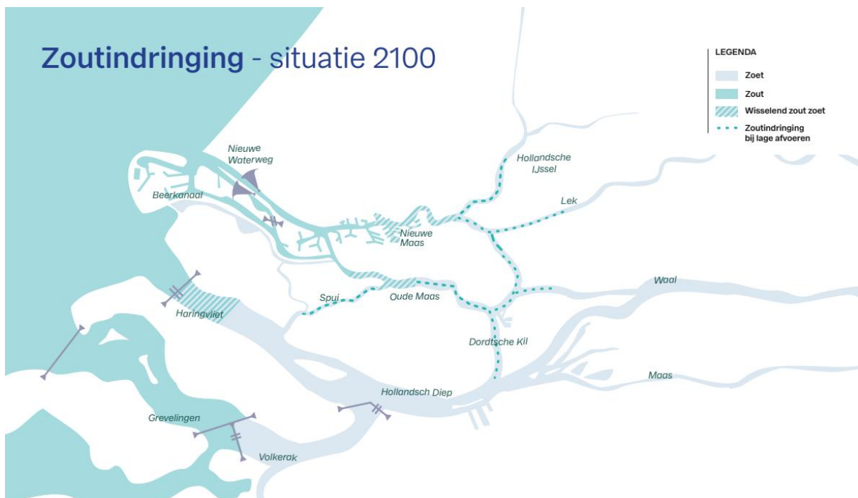
Figuur 20: Zoutindringing 2100 bij het Hd scenario (Vuik et al 2025) (let op, dit gaat uit van 0,8m ZSS en geen 2mZSS). De werkelijke zoutindringing in een droog jaar is dus groter, en daarmee ook de zoetwatervraag voor doorspoeling van het hoofdwatersysteem.
