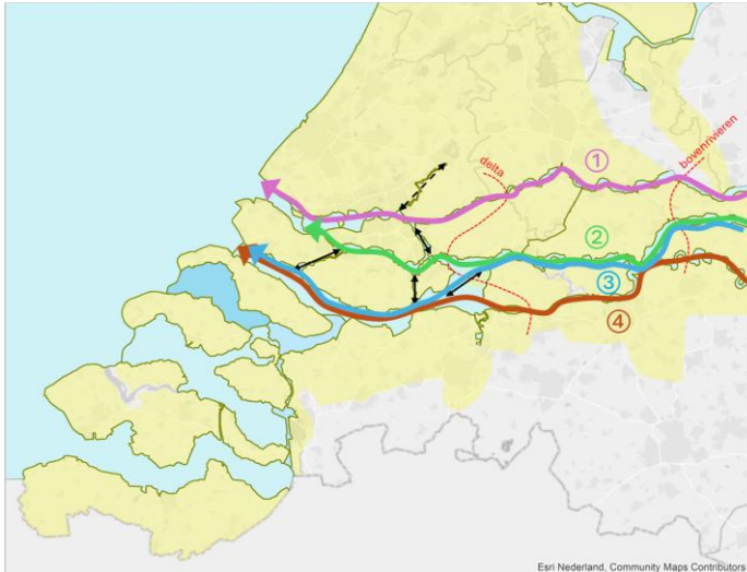
Figuur 9: Opbouw van de waterstand van beneden- naar bovenstrooms langs 4 tracés.
