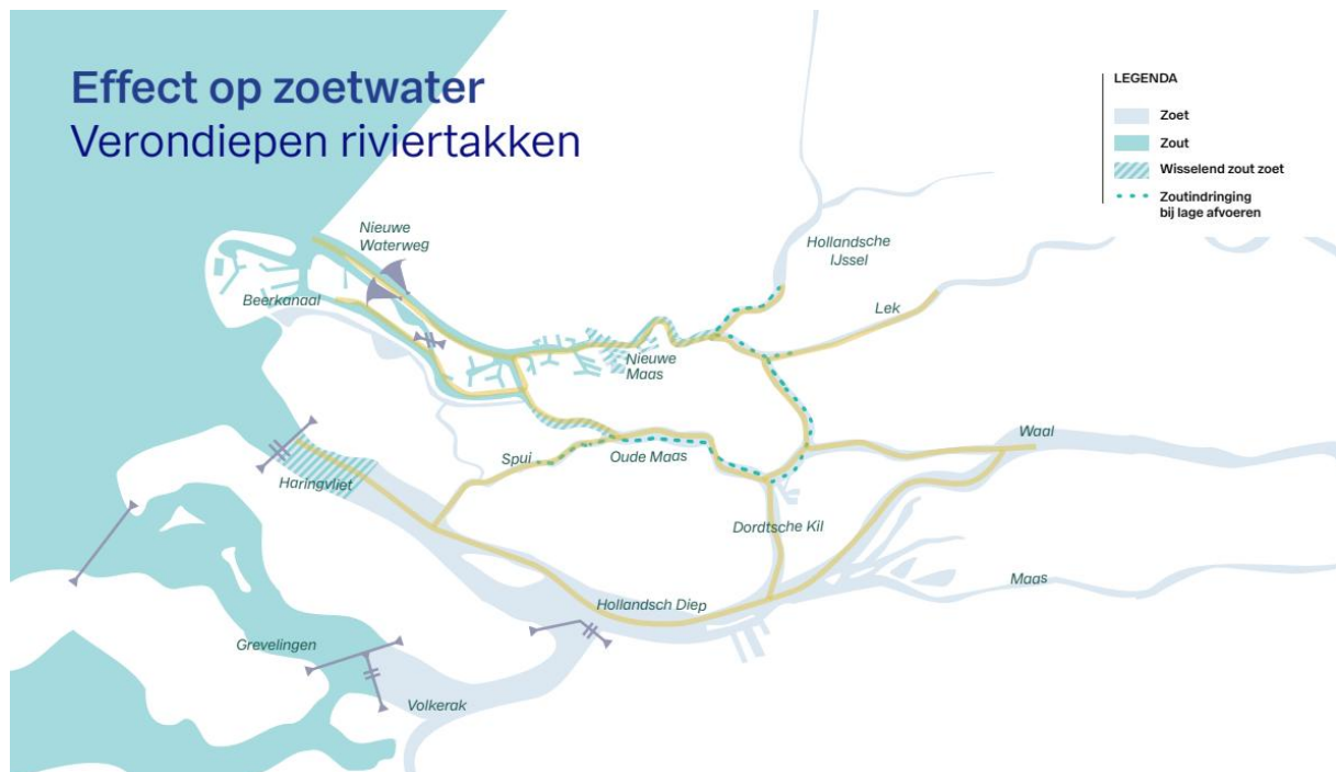
Figuur 21: Effecten op zoutindringing bij Hd2100 bij 2-3m verondieping op riviertakken (Vuik et al 2025).
