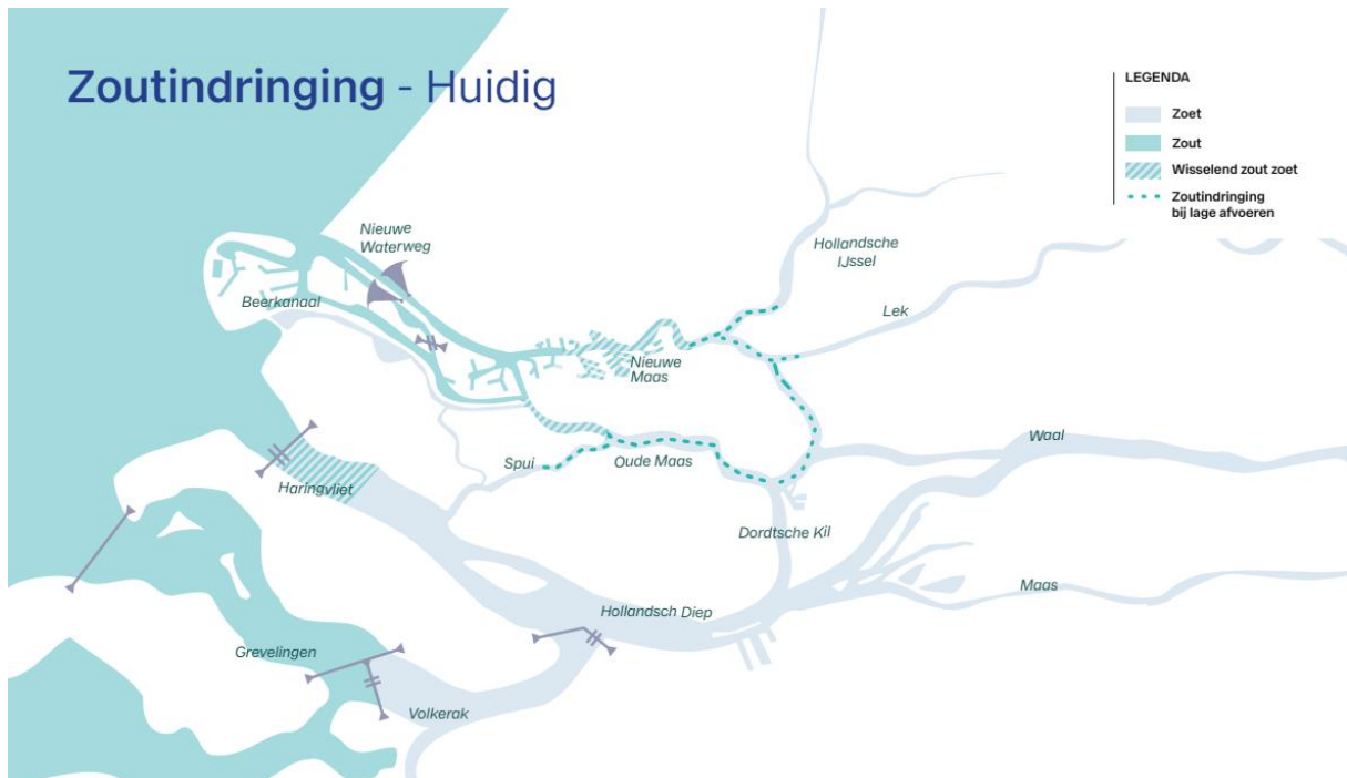
Figuur 19: Zoutindringing in het huidige watersysteem (Vuik et al 2025)
