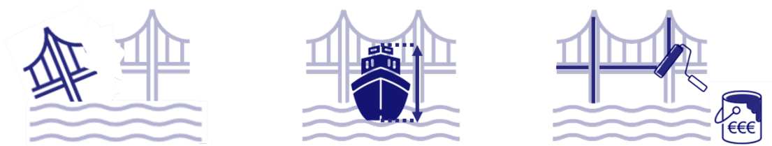
Figuur 1.3: Onderscheid tussen technische (links), functionele (midden) en economische (rechts) levensduur aan de hand van een voorbeeldbrug: gebrek aan constructieve integriteit (technisch), het niet kunnen voldoen aan eisen van de scheepvaart (functioneel), of te hoge onderhoudskosten (economisch) kunnen ervoor zorgen dat deze (voorbeeld)brug einde levensduur bereikt (KpNK, 2024d).
