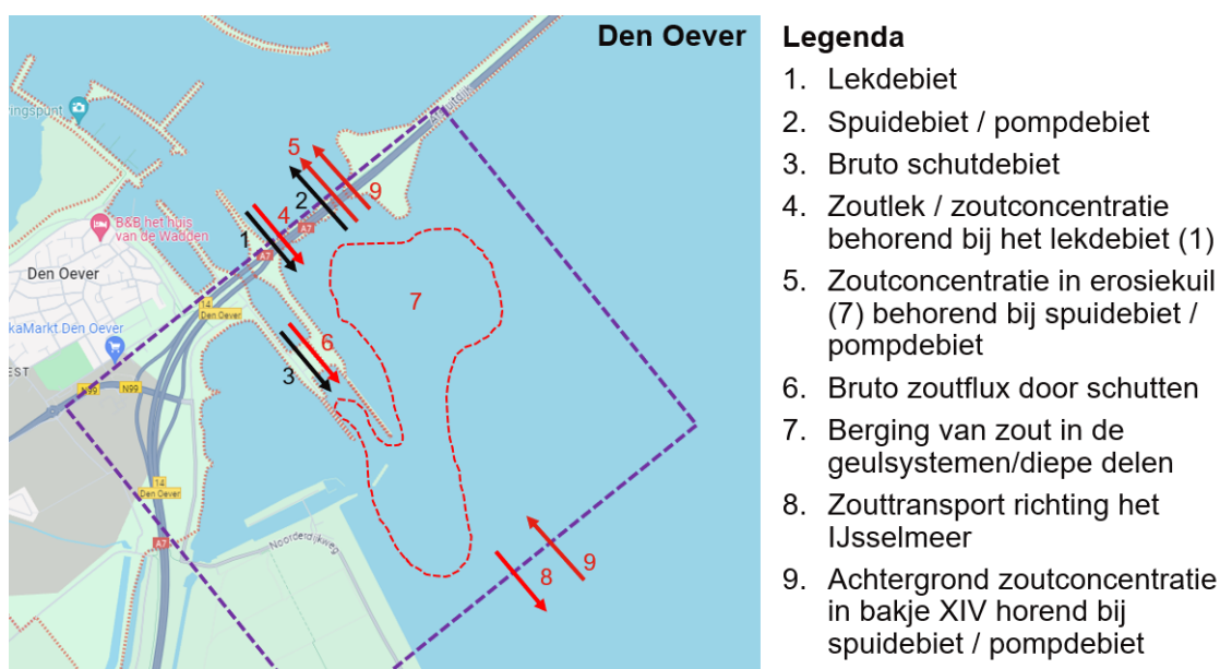
Figuur 2-2 De in- en uitfluxen van zout en water bij de sluiscomplexen van de Afsluitdijk. Voorbeeld: Den Oever.
