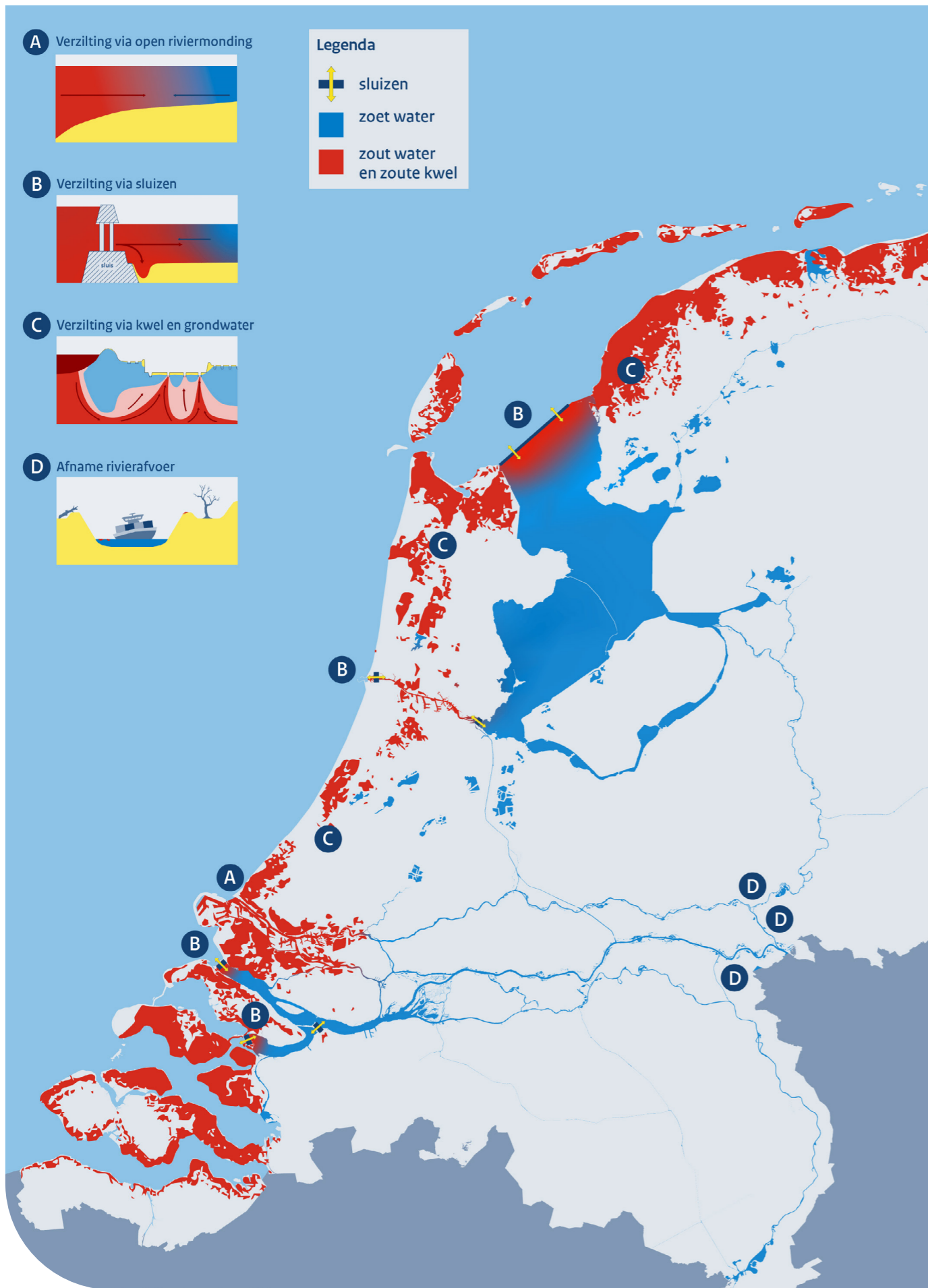
Figuur 17. Door de ligging nabij de zee komt er op drie manieren zout in het zoete binnenwater: via open riviermondingen, sluisen en grondwater. Door de afname van rivierwater is het steeds moeilijker om het zeewater weg te spoelen.
