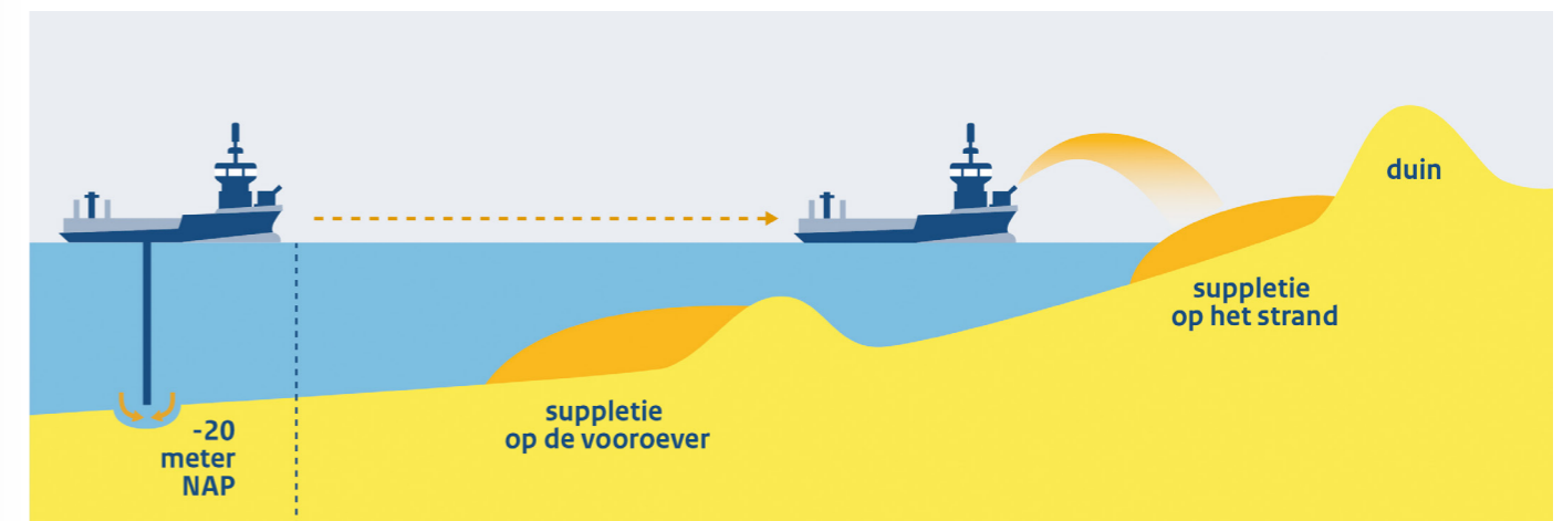
Figuur 7. We suppleren jaarlijks 11 miljoen kubieke meter zand in de kustzone, op de vooroever of op het strand. Het zand komt uit hiervoor aangewezen diepe delen van de Noordzee.
