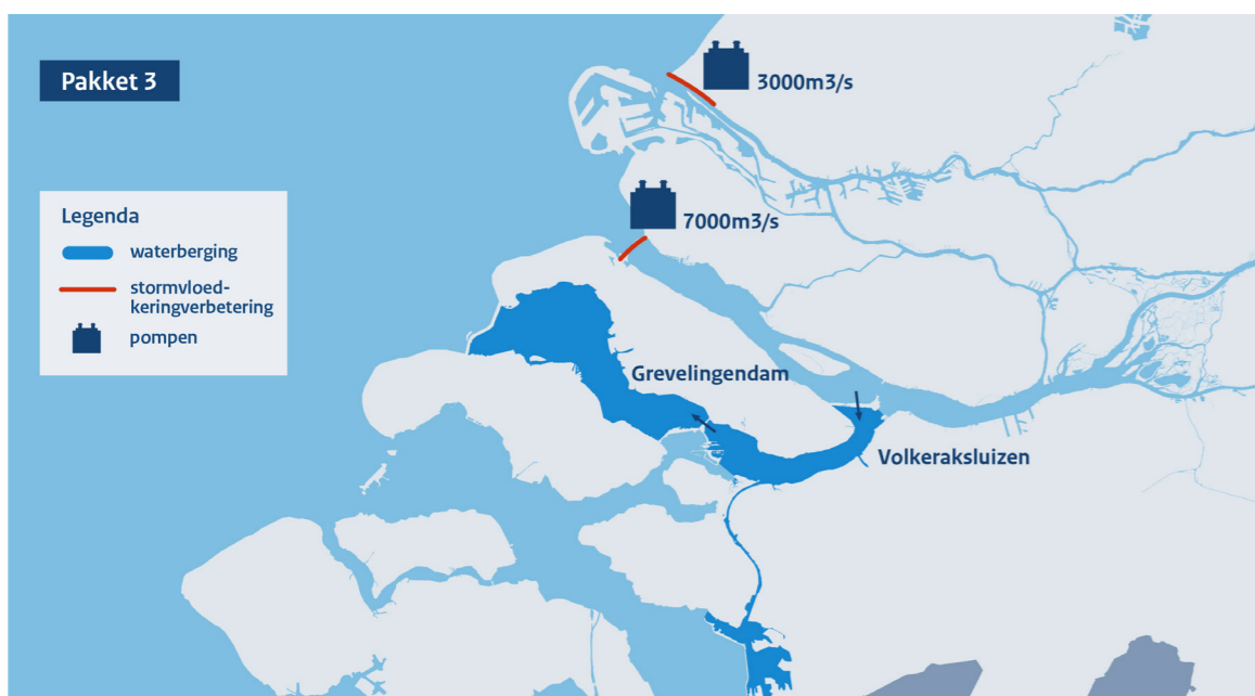
Figuur 14. In de drie onderzochte pakketten komt er steeds een extra maatregel bij om de waterstandsverhoging in de Rijn-Maasmond te beperken. Dijken versterken is de basis. Met pakket 1 wordt waterberging toegevoegd, met pakket 2 verbetering van de stormvloedkering en met pakket 3 grote pompen bij de Maeslantkering en de Haringvlietluizen.
