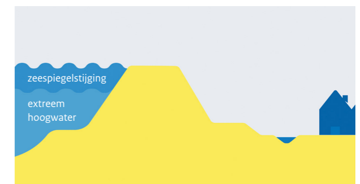
Figuur 4. Zeespiegelstijging leidt tot grotere belasting op de waterkeringen.
