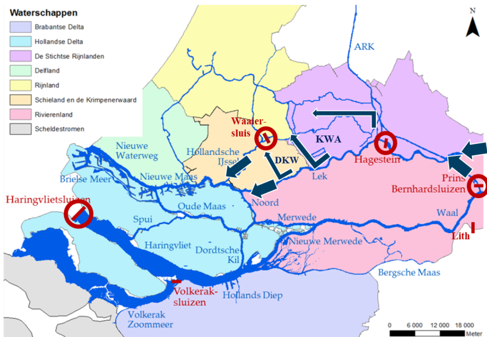
Figuur 5-2 Kaart van de RMM met daarin schematisch de stuwen en sluisen (rode balkjes) die invloed hebben op de waterverdeling en verzilting. De rode cirkels geven aan welke hiervan als reguliere stuurknop voor de RMM-zoetwaterstrategie fungeren. Donkerblauwe pijlen geven globaal de omlleidingen van de KWA weer en de surplus op de Lek en Hollandsche IJssel. Figuur aangepast o.b.v. Arcadis-HydroLogic 2023b. Zie ook Figuur 5-4.
