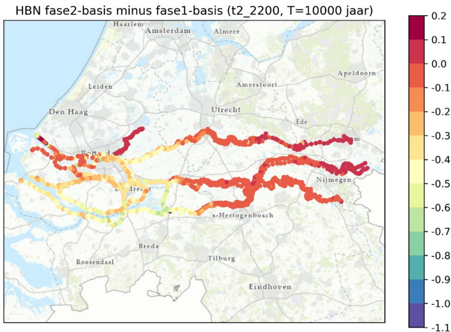
Figuur 41: Verschil in hydraulische belastingniveau T10.000 jaar tussen 'nieuwe' basissituatie en reproductie Zethof et al. (2023) voor tijdlijn Gematigd en zichtjaar 2200.
