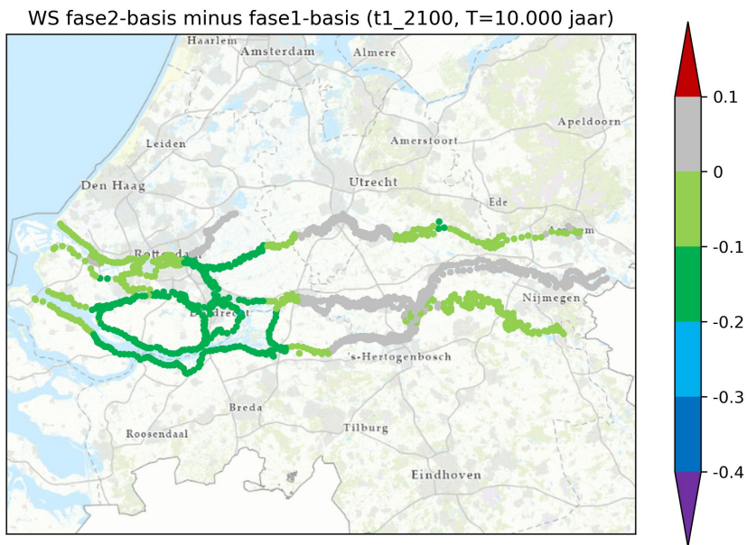
Figuur 36: Voorbeeld van geografisch overzicht van het verschil in waterstand (Hydra-NL) tussen basissituatie en maatregelen pakket 1 voor alle berekende locaties in tijdlijn Laag.
