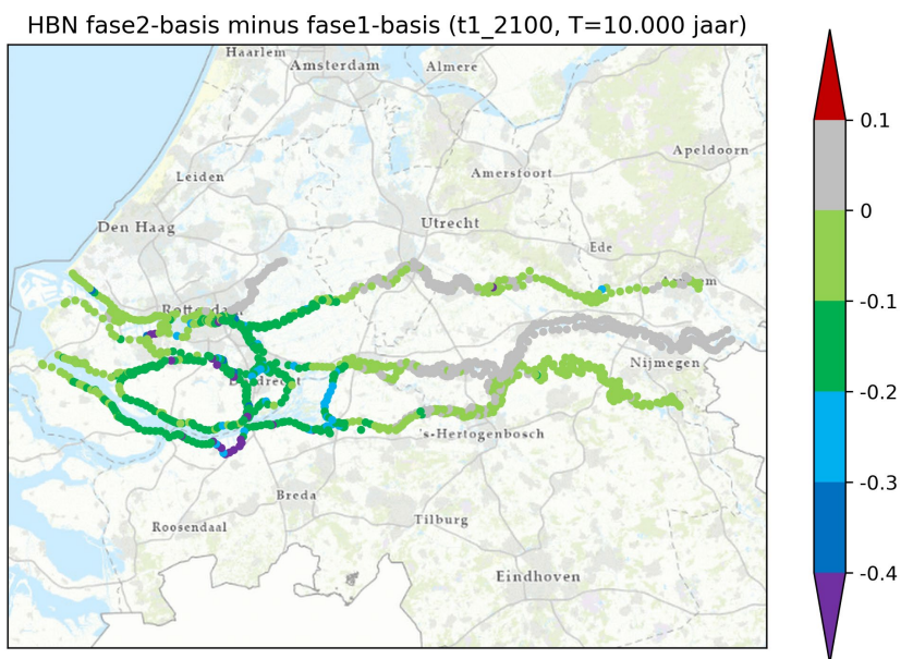
Figuur 37: Voorbeeld van geografisch overzicht van het verschil in hydraulisch belastingniveau (Hydra-NL) tussen basissituatie en maatregelen pakket 1 voor alle berekende locaties in tijdlijn Laag.
