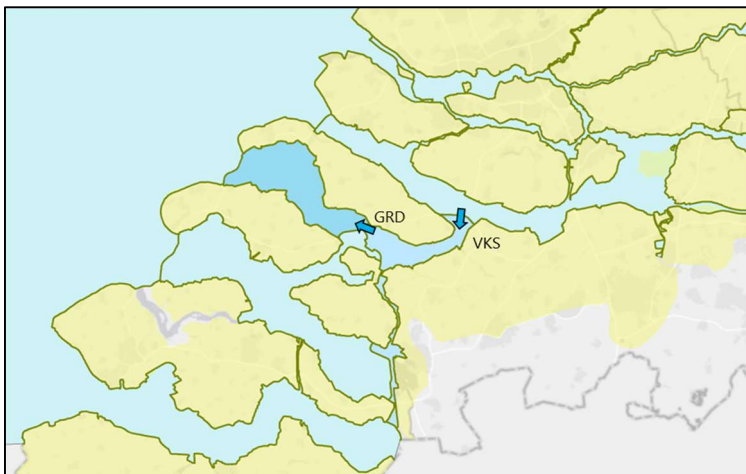
Figuur 14: Weergave maatregelpakket I met vergroting van doorstroomoppervlakte in de Volkerakdam en de Grevelingendam
