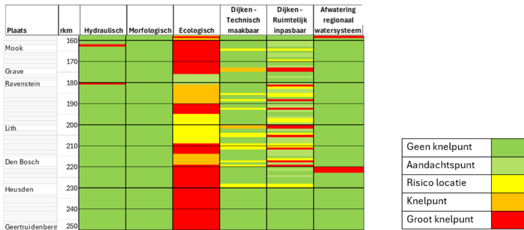
Figuur 6.4 Knelpunten bedijkte Maas. [bron: RvdR, rapport hydraulica en morfologie]
